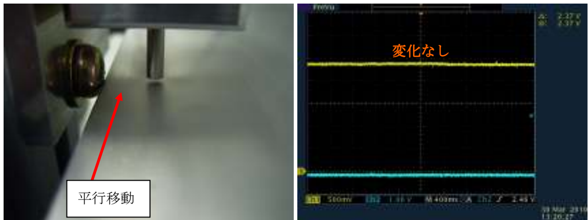
ニードルとアルミ板のギャップを一定にして、板を平行移動
